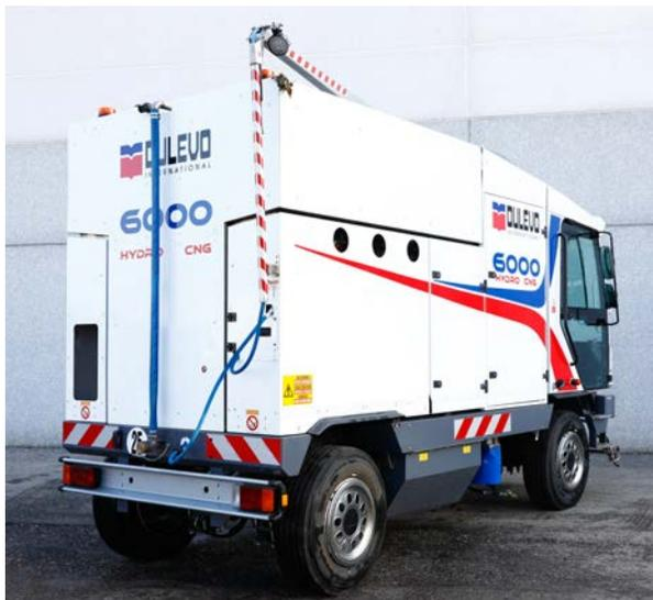
La máquina se puede configurar, según las necesidades del cliente, con sistemas de alta presión y sistemas de dosificación automática del producto higienizante.
