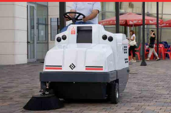
Le Dulevo 1100 e 1300 sono spazzatrici che offrono i migliori risultati nel campo della pulizia industriale e di interni. Grazie al loro design ultracompatto e ai meccanismi idraulici, sono estremamente maneggevoli, facili e piacevoli da guidare. La totale assenza di cinghie di trasmissione sui componenti del motore rende queste spazzatrici praticamente indistruttibili, contribuendo a ridurre significativamente i costi di manutenzione ordinaria.
