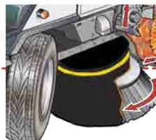
Los faldones especiales montados en los cepillos laterales permiten una limpieza totalmente en seco.
