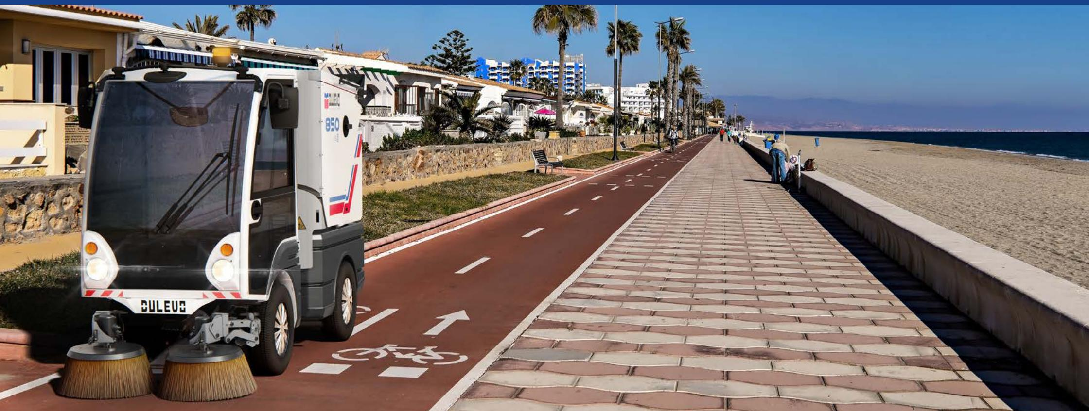
L'innovativa struttura modulare, priva di componenti elettronici, con trasmissione a cinghia e con serbatoi d'acqua collocati di lato e facilmente smontabili, agevola l'accesso a tutti i componenti principali per la manutenzione e la riparazione. Un ulteriore sportello di manutenzione posto sotto il sedile del guidatore ed il vetro frontale convesso, agevolano le operazioni giornaliere sulla bocca e sul tubo di aspirazione.
