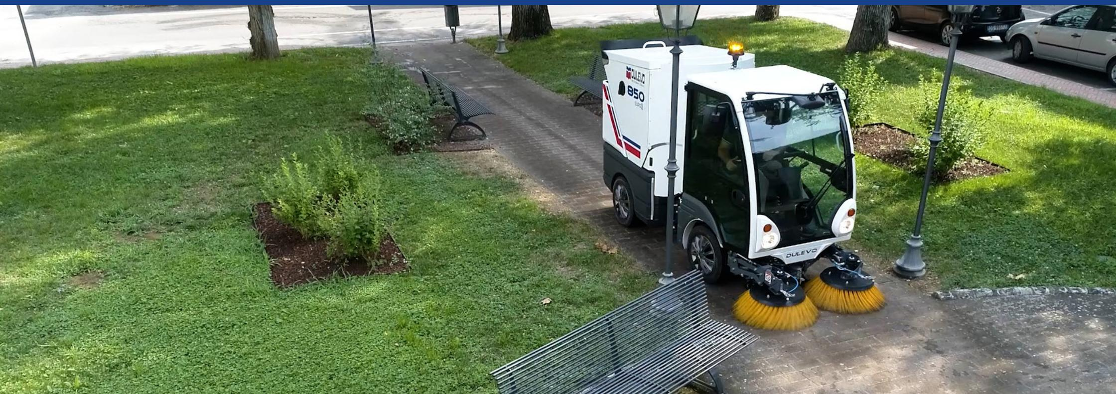
Les brosses latérales avec mouvement complet sont l'idéal pour brosser les coins et les goulottes d'évacuation, et pour augmenter la surface de travail. Le vaste vitre avant convexe garantit à l'opérateur une vue excellente sur la bouche d'aspiration. L'est possible d'ajouter une unité à haute pression et un tuyau d'aspiration manuel comme instruments de travail en option, pour agrandir la gamme des opérations possibles.
