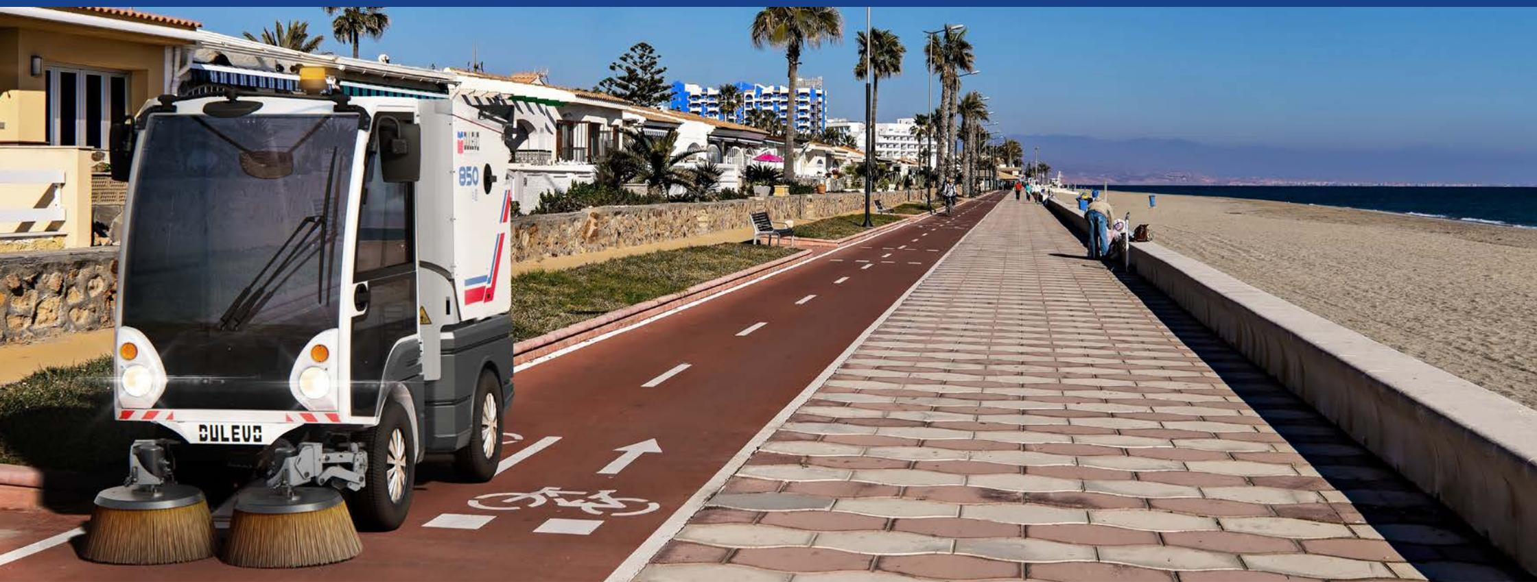
La structure modulaire innovante, sans composants électroniques et avec une transmission hydraulique et des réservoirs à eau placés sur le côté et faciles à démonter, facilite l'accès à tous les composants principaux, pour l'entretien et les réparations. Une autre porte d'entretien, située sous le siège du conducteur, et la vitre frontale convexe facilitent les opérations quotidiennes sur la bouche et le tuyau d'aspiration.
