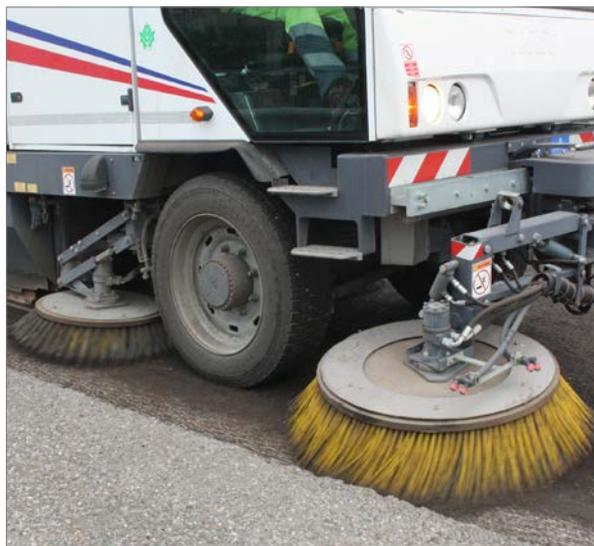
Die große Frontbürste mit voller 180-Grad-Bewegung ist ein unverzichtbares Hilfsmittel zum Kehren von Ecken und Wasserrinnen sowie zur Vergrößerung der Arbeitsfläche.
