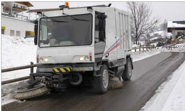
**D**ie Kehmaschine Dulevo 5000 Veloce kann eine Geschwindigkeit von 70 km/h erreichen und wird häufig von Gemeinden und Städten eingesetzt, die für den Einsatz große Entfernungen zurücklegen müssen und bei denen daher eine hohe Überführungsgeschwindigkeit erforderlich ist.
