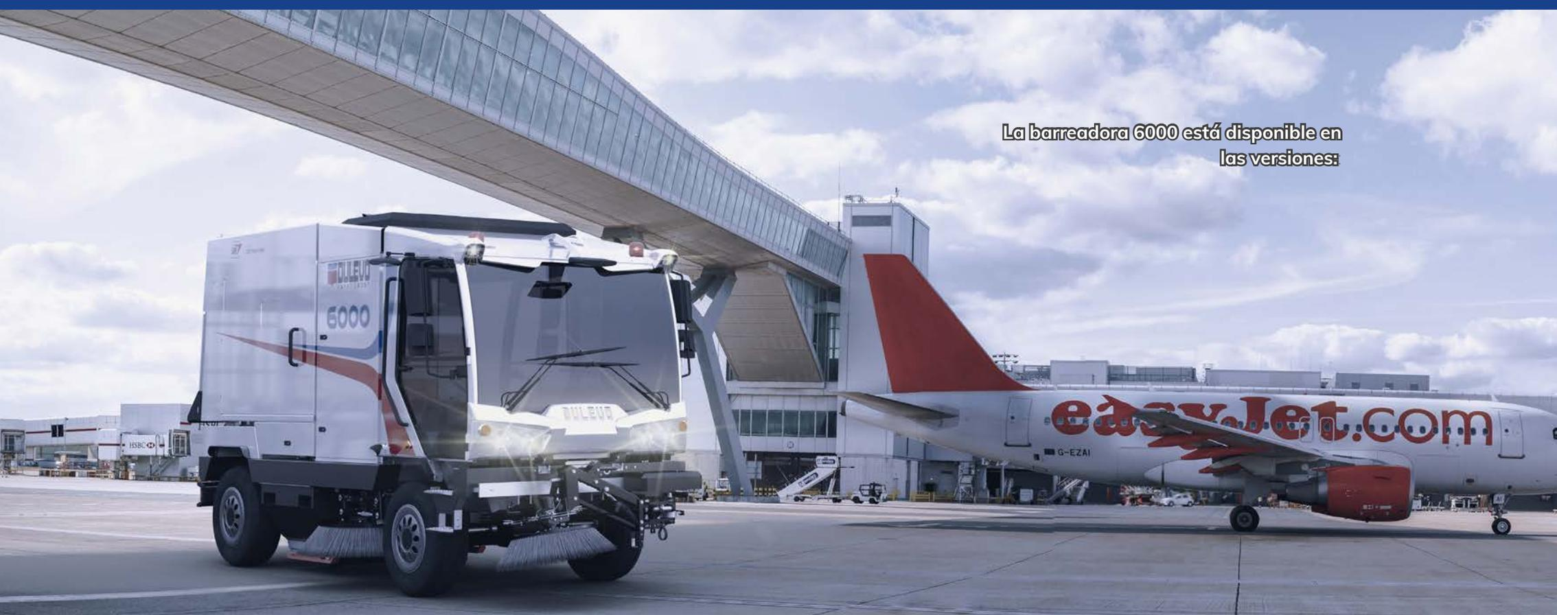
La versión **Dulevo 6000 Combi** ofrece máquina para uso combinado. Esta máquina combina las funciones de barrer y baldear/desinfectar. La máquina, con un solo operario y directamente desde el asiento del conductor, puede barrer y baldear/desinfectar simultáneamente y en una sola pasada.
