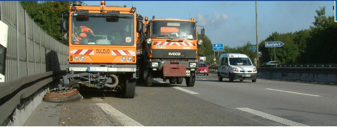
En colaboración con Gore®, Dulevo ha desarrollado la única barredora a nivel internacional con filtración total del polvo fino. Este sistema de aspiración-filtración mecánica asegura, junto a la aplicación exclusiva de la tecnología Gore®, un abatimiento total de las
