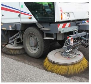
El resistente cepillo delantero caracterizado por un movimiento de 180°, es una herramienta auxiliar indispensable para limpiar las esquinas y las alcantarillas, y para ampliar la anchura de trabajo.
