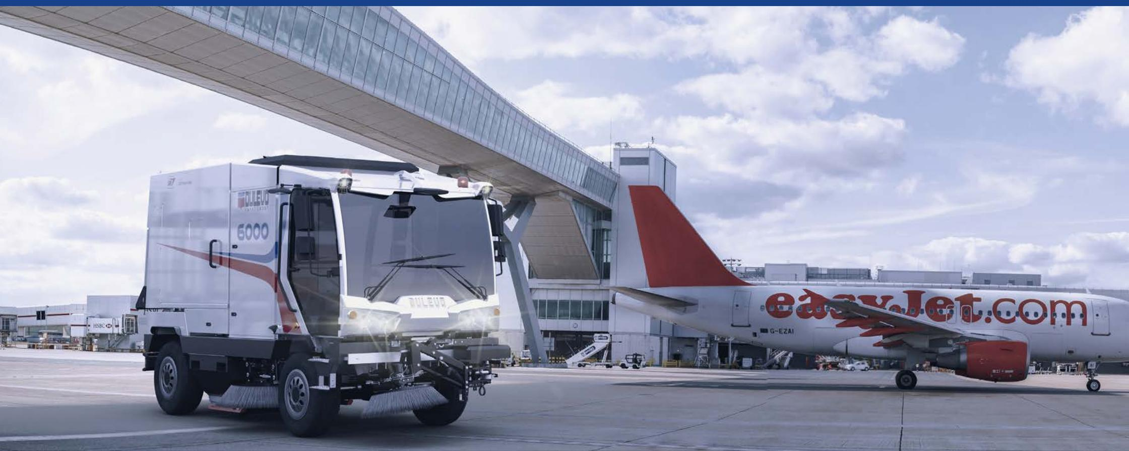
La versione **Dulevo 6000 Combi** combina le funzioni di spazzamento e lavaggio / sanificazione. La macchina, con un solo operatore e direttamente dal posto di guida, può spazzare e lavare / sanificare allo stesso tempo e con un solo passaggio operativo. La lancia ad alta pressione con braccio agevolatore permette ad un secondo operatore di lavare e sanificare marciapiedi anche in presenza di auto parcheggiate.
