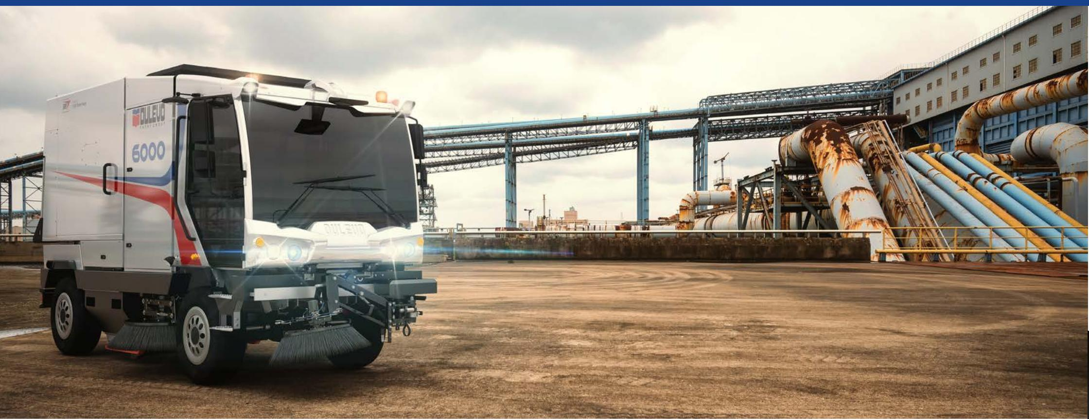
In collaborazione con Gore®, Dulevo ha sviluppato una spazzatrice con filtrazione totale delle polveri, unica al mondo. Il sistema meccanico di filtrazione e aspirazione garantisce l'abbattimento totale delle particelle PM10, grazie all'applicazione esclusiva della tecnologia Gore®.
