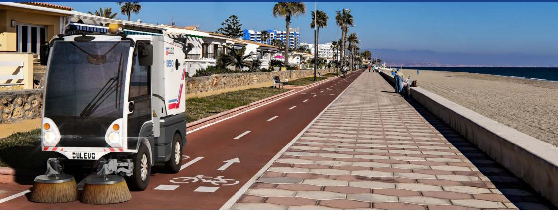
La estructura innovadora y modular, sin componentes electrónicos y de transmisión por correa, y la facilidad de extracción de los tanques del agua montados lateralmente, simplifican el acceso a todos los elementos más importantes en caso de revisión y mantenimiento. Una compuerta adicional para mantenimiento debajo del asiento del conductor y la ventana ayudan diariamente y de forma sencilla en las operaciones en la boca y la manguera de aspiración.
