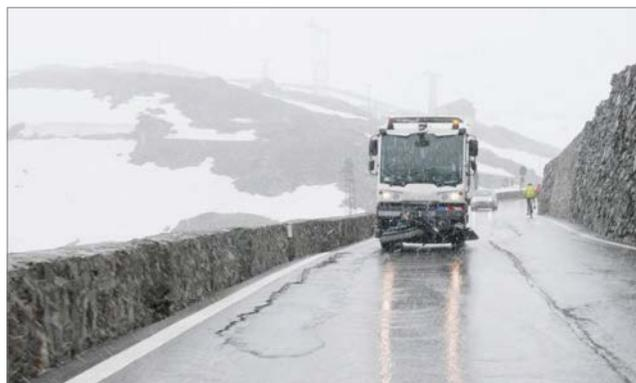
La 6000 CNG garantisce una rumorosità minima, nessuna emissione di polvere in atmosfera, nessun agente inquinante proveniente dalla combustione di gasolio della spazzatrice stessa e la certezza assoluta di fornire alle amministrazioni una macchina davvero a "emissioni zero".
