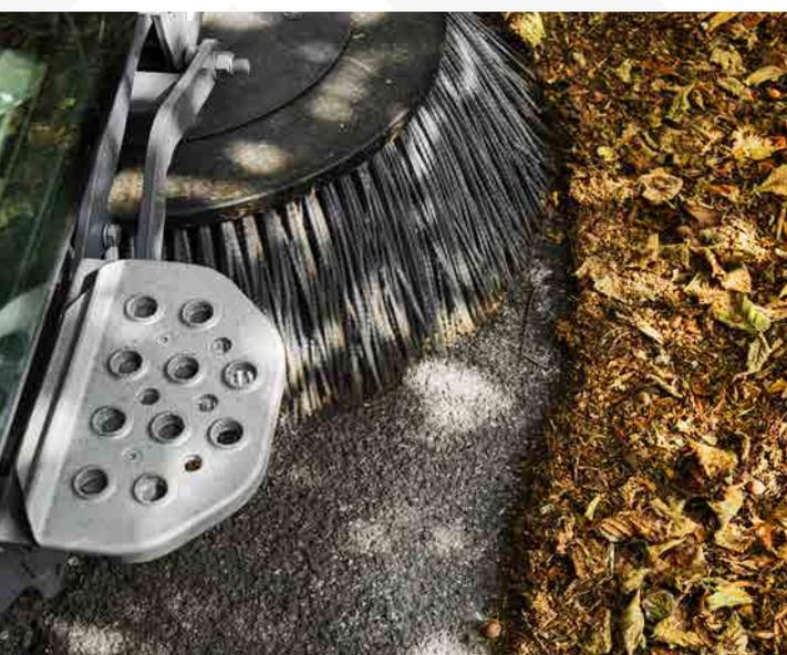
L'utilisation de matériaux légers et performants tels que l'aluminium et le polyéthylène, l'assemblage à l'aide de techniques innovantes et l'optimisation extrême garantissent la robustesse et l'efficacité maximale, tout en maintenant la masse totale chargée à moins de 3 500 kg. Grâce aux pneus spéciaux surdimensionnés (en option), la pression au sol reste inférieure à 3 kg/cm², ce qui est idéal pour les surfaces délicates qui doivent être nettoyées en profondeur sans être endommagées.
