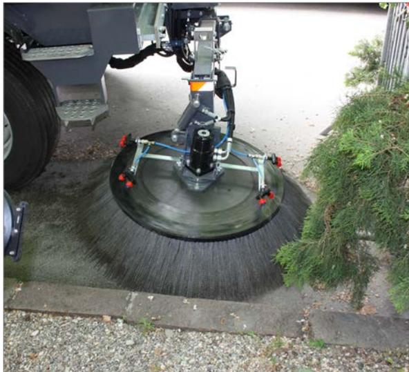
Die große Frontbürste mit voller 180-Grad-Bewegung ist ein unverzichtbares Hilfsmittel zum Kehren von Ecken und Wasserrinnen sowie zur Vergrößerung der Arbeitsfläche. Mit dem trichterförmigen Hebesystem können die Abfälle in die entsprechenden Container, Lastwagen oder großen Müllpressen entladen werden. Durch die Vielfalt der angebotenen Optionen kann das Einsatzspektrum der Dulevo 6000 CNG jederzeit und überall erweitert werden.
